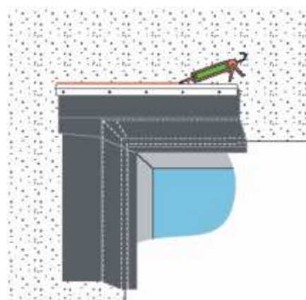
Rys.4 Aplikacja uszczelnacza bitumicznego illbruck OT11 przy listwie zabezpieczającej połączenie górne.
